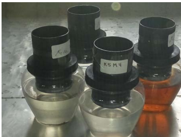
Gambar Model lavitrap dengan tinggi lubang bagian atas 7 cm dan bawah 3.5 cm
